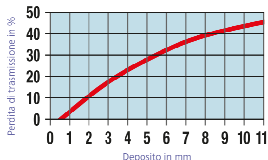
Perdita di efficienza causata dal calcare Uno strato di calcare di soli 2 mm sull'elemento riscaldante causa una perdita nel trasferimento di calore del 15% circa.
