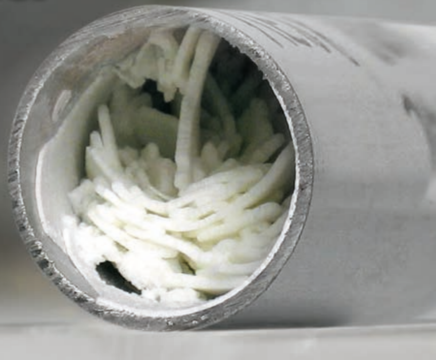
Perdita di efficienza causata dal calcare Uno strato di calcare di soli 2 mm sull'elemento riscaldante causa una perdita nel trasferimento di calore del 15% circa.
